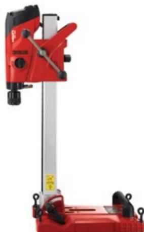
El sistema de máxima versatilidad DD 160-U puede ser operado desde una plataforma o manualmente y se puede utilizar para perforaciones en superficies secas y húmedas de distintos materiales base. Al perforar para aplicaciones eléctricas, el DD 160-U tiene un motor de alto rendimiento de 3 velocidades. También cuenta con características fáciles de usar como su LED de control de potencia que ayuda a los usuarios a alcanzar la penetración correcta y maximizar la vida de las brocas.
